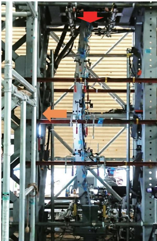
ステンレス長柱の座屈実験（共同研究で土木研究所で実施）
