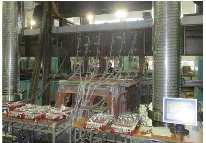
合成桁の荷重実験
